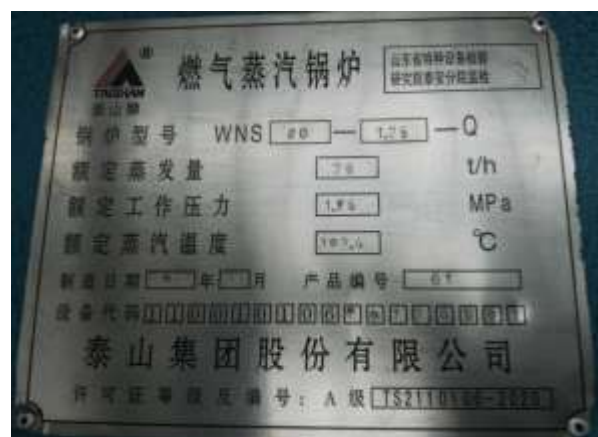
天然气锅炉铭牌
