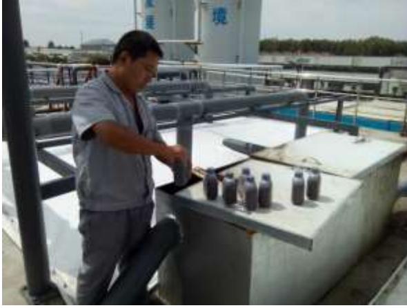
厂区污水处理站进口采样
